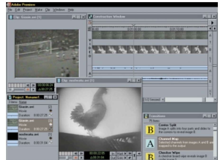
Εικόνα 3-42. Εργαλείο επεξεργασίας βίντεο. Ένα ή περισσότερα θέματα βίντεο τοποθετούνται σε γραμμές (κανάλια) χρόνου. Το περιεχόμενο κάθε βίντεο παρουσιάζεται καρέ-καρέ πάνω στο αντίστοιχο κανάλι. Συμβουλευόμενος ο χρήστης τη γραμμή χρόνου κόβει τα θέματα και τα τοποθετεί στο κανάλι που περιέχει το τελικό αποτέλεσμα. Η τεχνική ονομάζεται A/B Roll Montaz.
